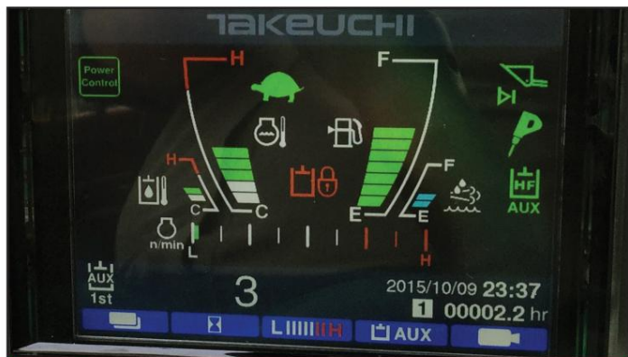
5,7" fargeskjerm med ryggekamera
