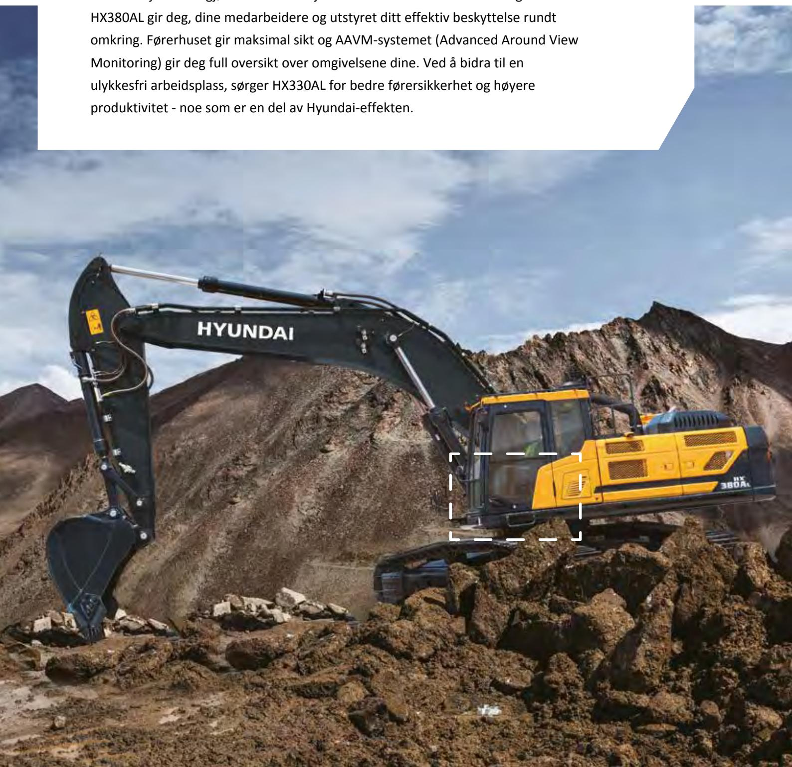
**Hyttestruktur** Førerhusstrukturen er forsterket med integrert sveiset, høyfast stål med små indre spenninger. Førerhuset er sertifisert i henhold til sikkerhetsstandardene ISO 12117-2 (ROPS, veltebeskyttelse) og ISO 10262 nivå 2 (FOPS, beskyttelse mot fallende gjenstander).
